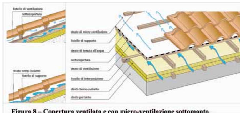
Figura 8 – Copertura ventilata e con micro-ventilazione sottomanto.
