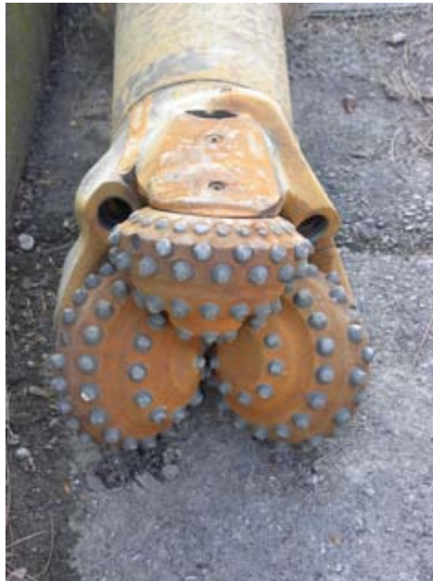
Fig. 15 scalpello a rulli conici (tricono o rock bit)
